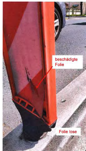
Folie beschädigt und lose
