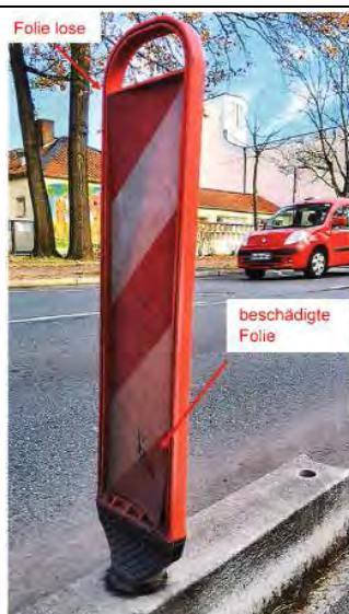
Folie beschädigt und lose
