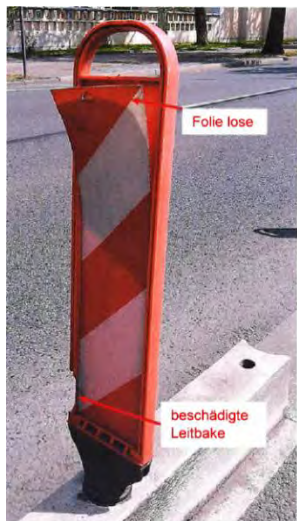
Kunststoff beschädigt, Folie lose (Vgl. Prüfbericht Nr. 18211206)
