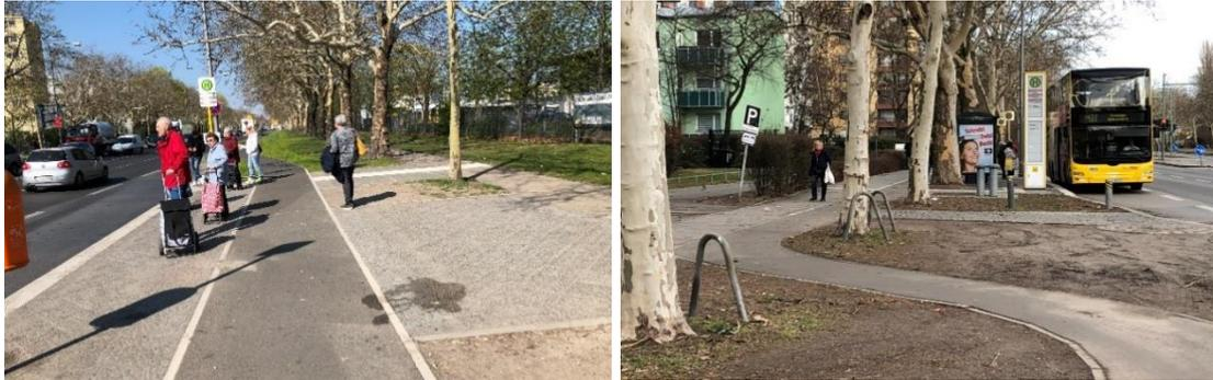
Abbildung 58: Radverkehrsführung durch und hinter den Haltestellenbereich in Berlin-Spandau (Heerstraße)<sup>25</sup>
