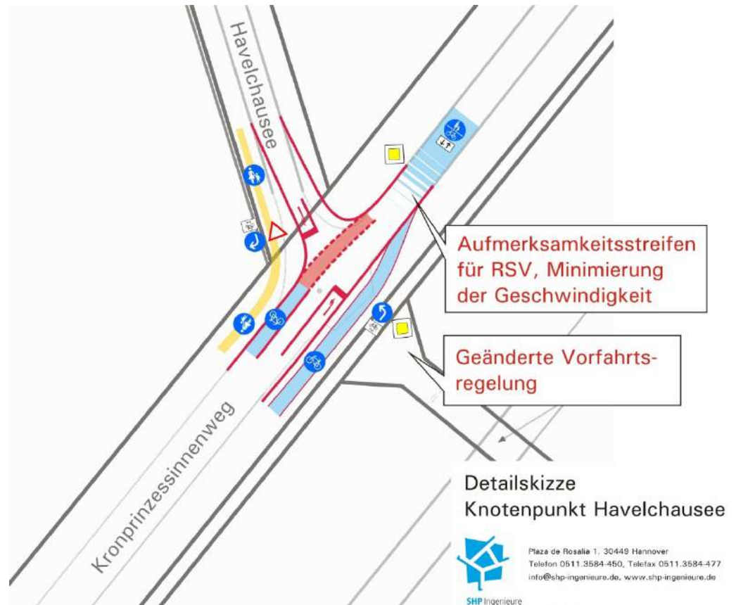
Abb. 37 Detailskizze Knotenpunkt „Havelchaussee“ mit LSA-Vorrang für die RSV
