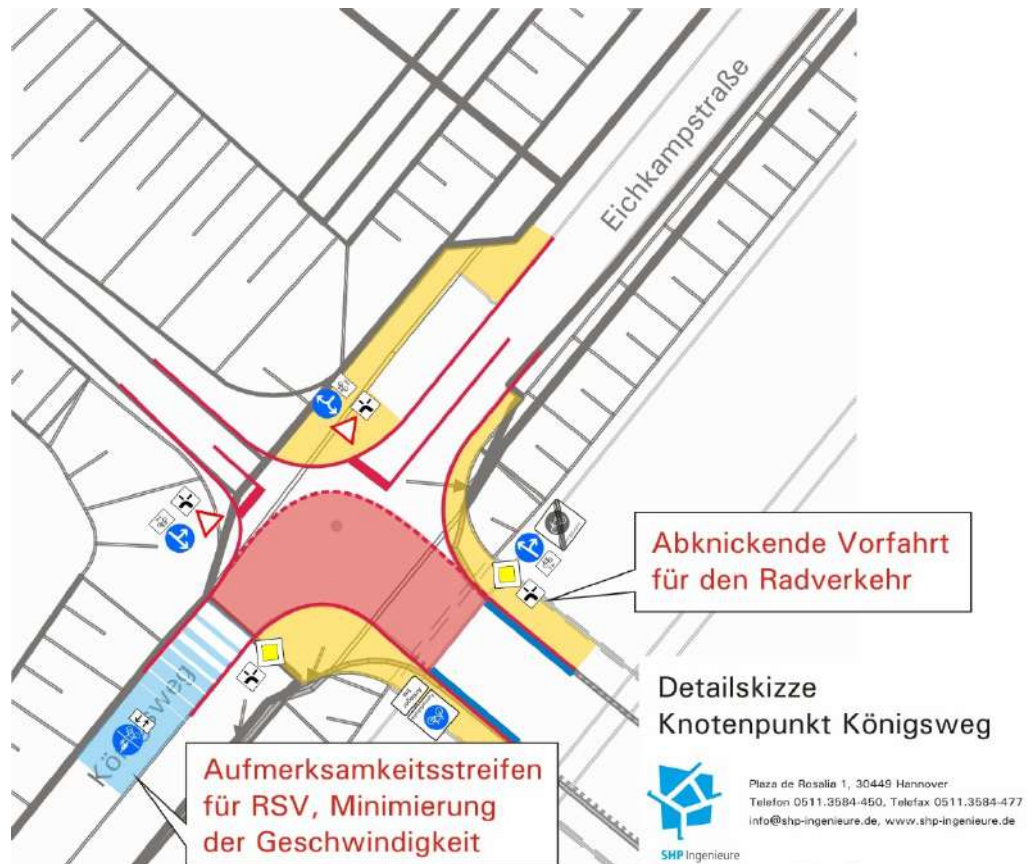
Abb. 29 Detailskizze Knotenpunkt Königsweg mit neuer LSA und Bevorrechtigung des Radverkehrs
